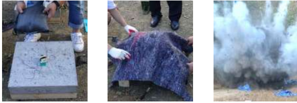
(a) TNT 및 모래주머니 설치 (b) 보호덮개 설치 (c) 폭파 모습
