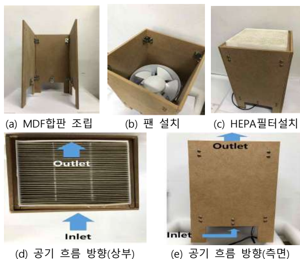
그림 1. DIY 공기청정기의 제작 과정 및 구조
