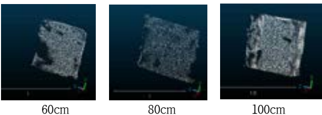
그림6. PCD데이터를 평면 피팅한 모습
