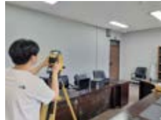
그림 3. 광파기를 사용한 측정 모습
