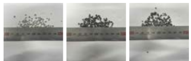
a) 전기로 환원슬래그 b) 전기로 산화슬래그 c) 전로 슬래그 그림 2. 슬래그 입형
