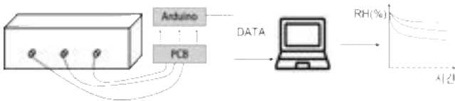
그림 3. 콘크리트 온·습도 계측 개념도
