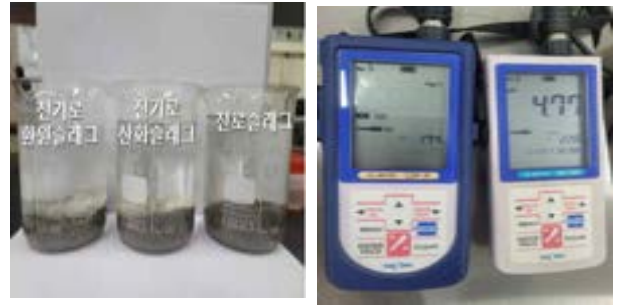
a) 침지수에 따른 샘플 시료 b) ppm 및 pH 측정기기 그림 3. 수소이온농도 및 이산화탄소 농도 측정장비
